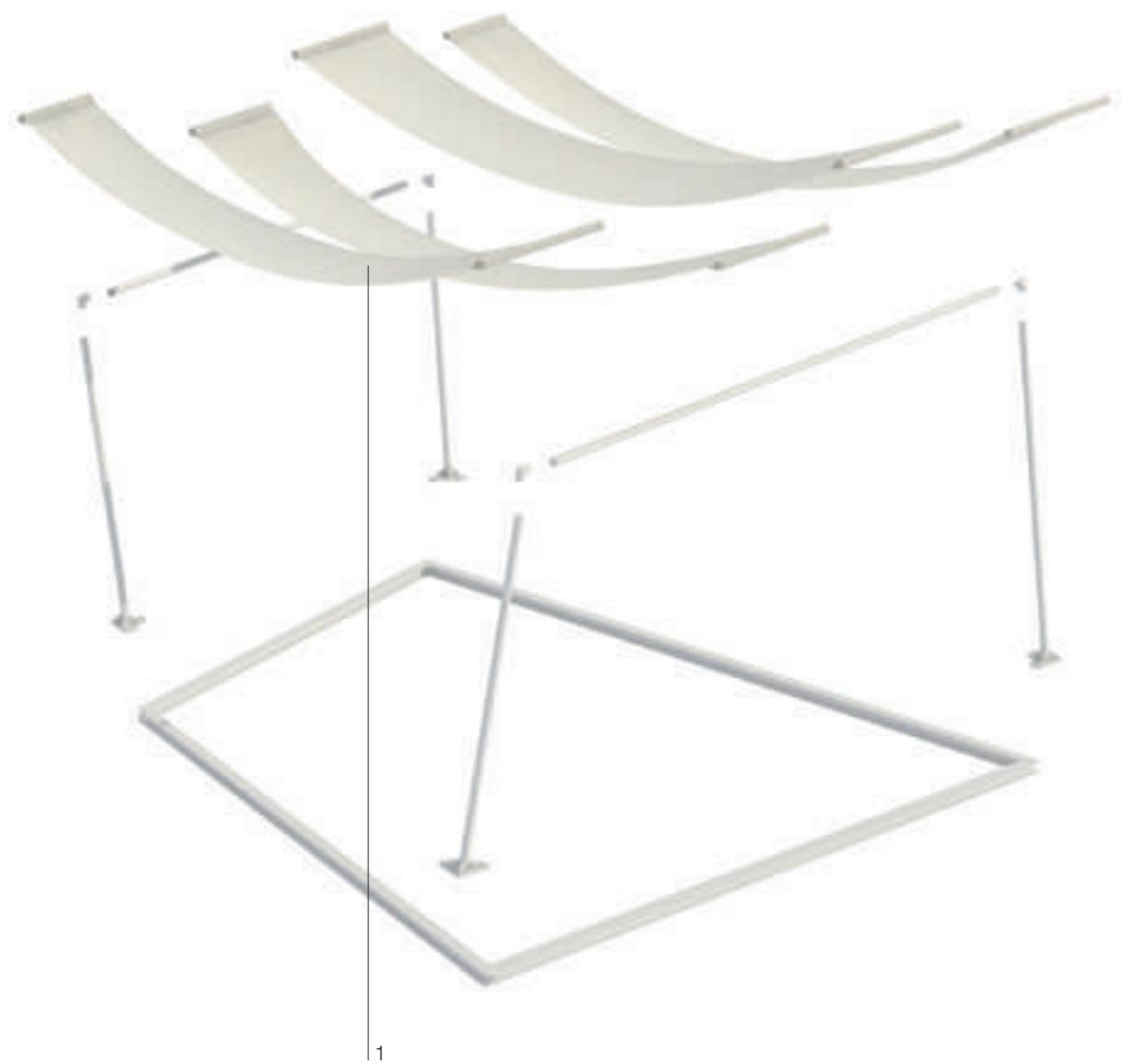
1 Telo di copertura, fabric covering, toile de couverture, vela de cobertura, Stoffsegel.
