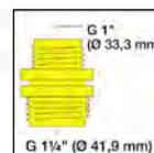
**Raccordo di collegamento alla elettropompa da G1**
